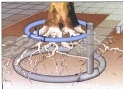
Figuur 38 - Beluchting en watergeefstelsysteem
