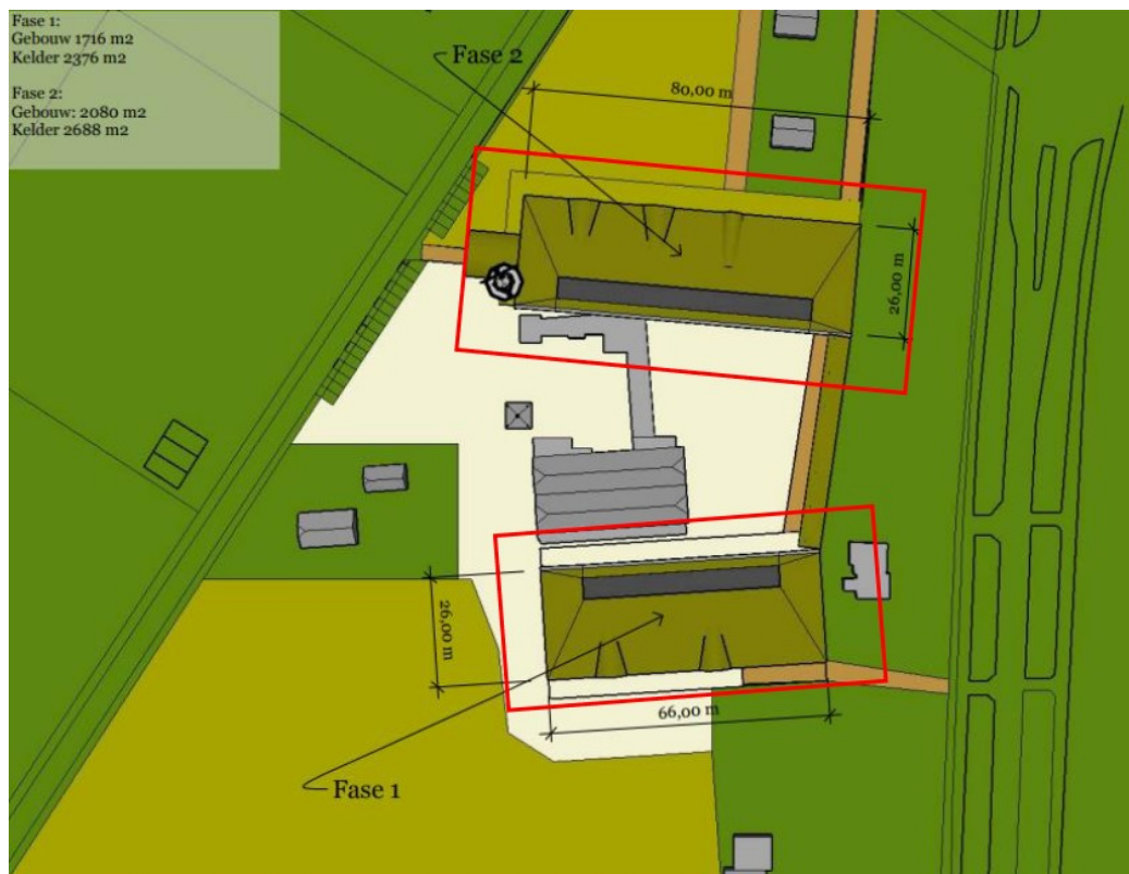
4 tekening bebouwing bovengronds, inclusief taluds en afmetingen
