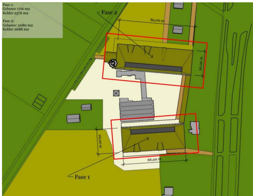
4 tekening bebouwing bovengronds, inclusief taluds en afmetingen
