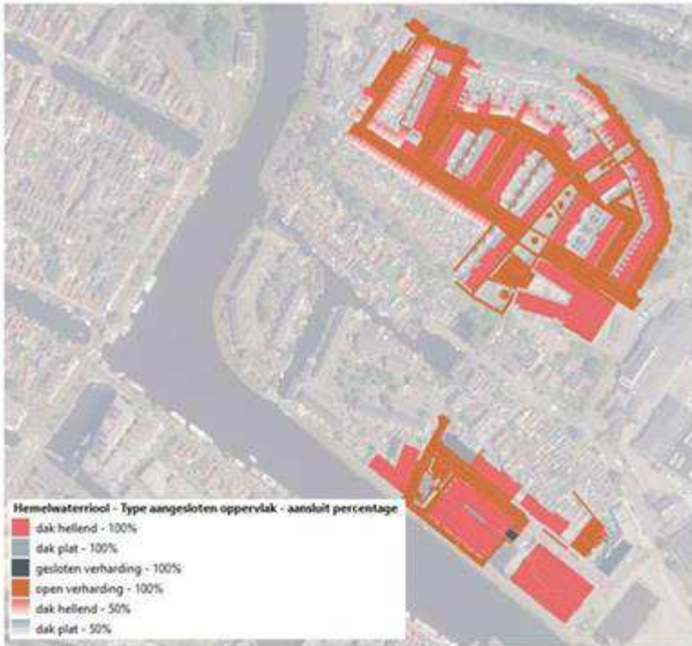
Figuur 10 Aangesloten verhard oppervlak hemelwaterrioolstelsel
