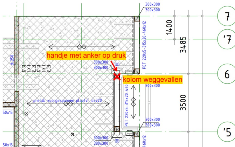
Fragment kolom falen met druk op handje als gevolg
