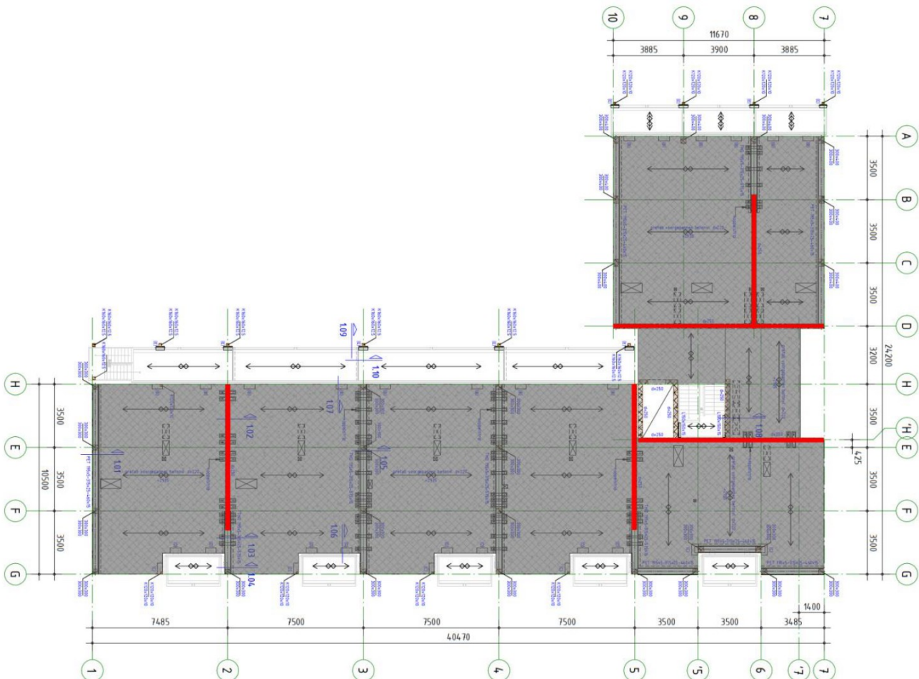
Figuur 2 Overzicht stabiliteitsverbanden
